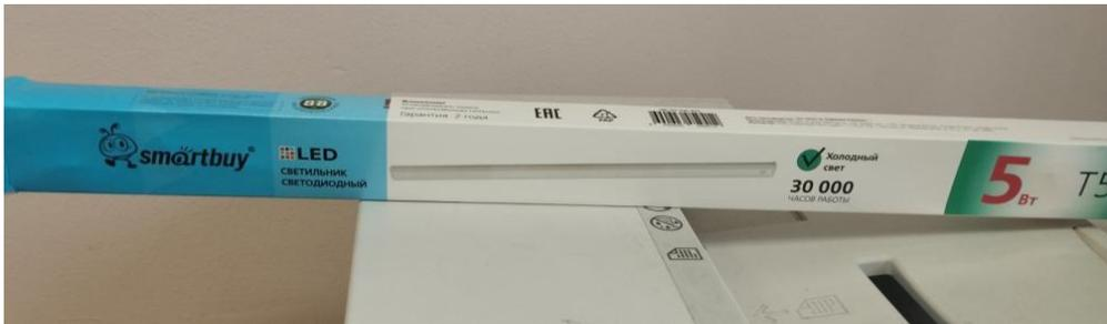
Квазипиковые значения напряжения радиопомех, создаваемых на сетевых зажимах, превышают допустимые нормы
